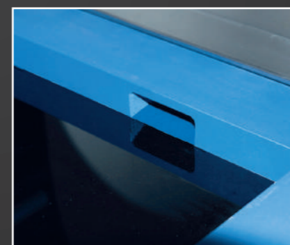
Canalina di scolo oli e grassi residui
